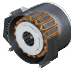
较少的转动部件—主机与电机之间采用直联结构，免去由于使用皮带、联轴器或是齿轮产生的传动损失
